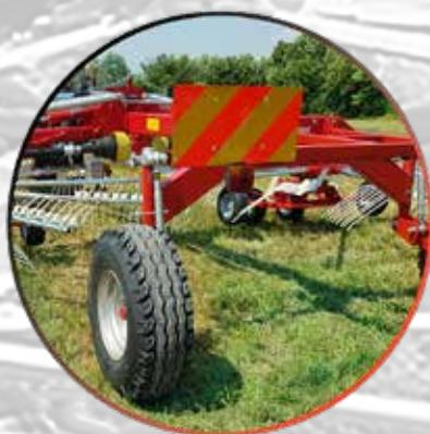
Regolazione idraulica assale posteriore per ridurre altezza nel trasporto stradale
