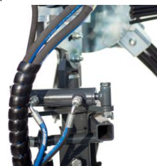
Pistone idraulico per regolare l'inclinazione. Hydraulic piston for inclination adjustment. Hydraulische Regulierung Der Neigung
